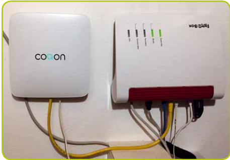
■ Das Herzstück des Smart Homes von Familie Meyer, die Qbox von Coqon, wird einfach per LAN-Kabel an den bestehenden Internetrouter angeschlossen
